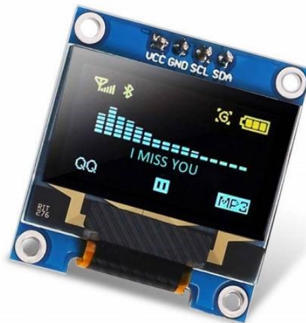
Obrázek 11. IIC I2C OLED displej
