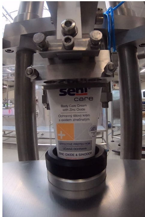
Obr. 13 Proces uzavření horní části tuby
