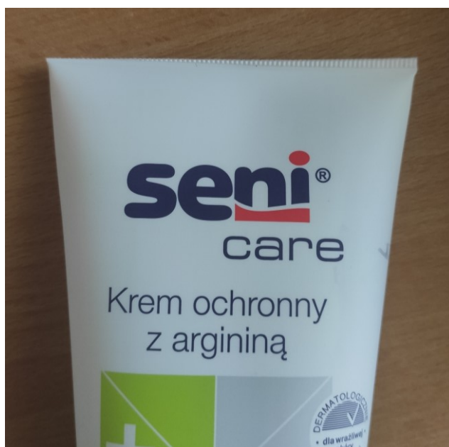
Obr. 28 Detail zastřížení v nesprávné výšce tuby
