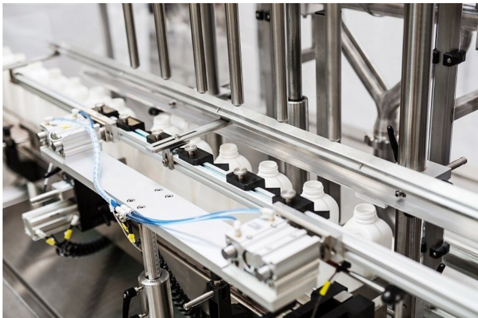
Obr. 2 Detail lineárního plnicího stroje se šesti plnicími tryskami [3]
