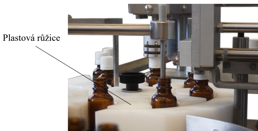
Obr. 1 Detail plnění a uzavírání lahviček na rotačním monobloku [2]
