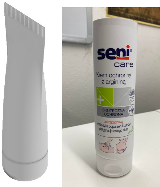
Obr. 30 3D model svařené, zašpičaté plastové tuby vytvořený v Autodesk Inventor a testovaná tuba před procesem uzavírání
