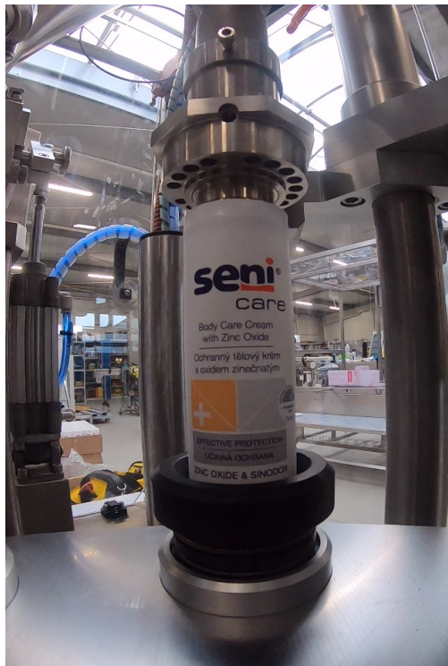
Obr. 12 Proces nahřívání horní části tuby
