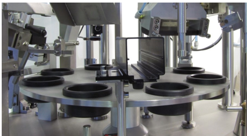
Obr. 7 Otočný stůl tubovacího stroje s plastovými pouzdry k založení tuby [8]
