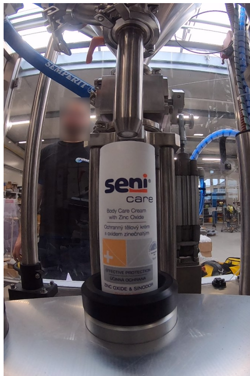
Obr. 11 Proces plnění tuby plnicí tryskou
