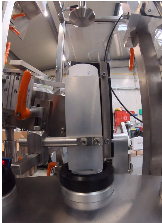
Obr. 9 Proces zakládání tuby do pouzdra
