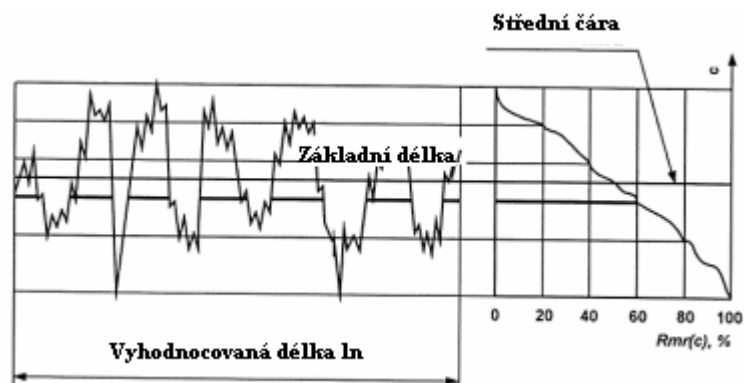
Obr. 5. Profilová a nosná křivka drsnosti profilu
