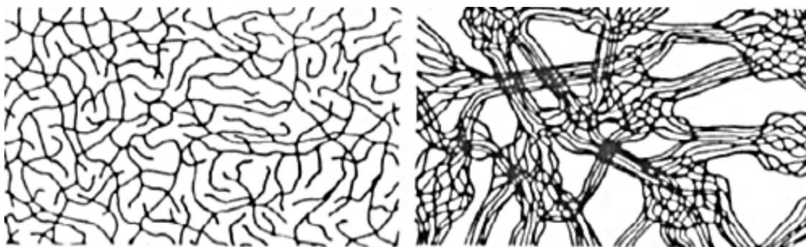
Obr. 2 Schéma struktury amorfního (vlevo) a semikrystalického (vpravo) termoplastu [16]
