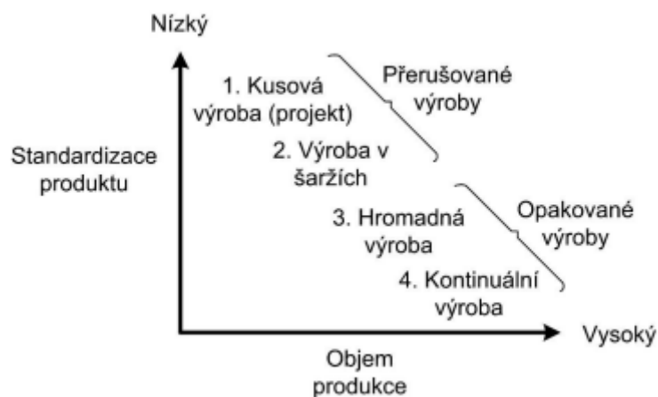
Obrázek 4 Srovnání typů výrob podle objemu a standardizace produktu Keřkovský (2012, str. 52)
