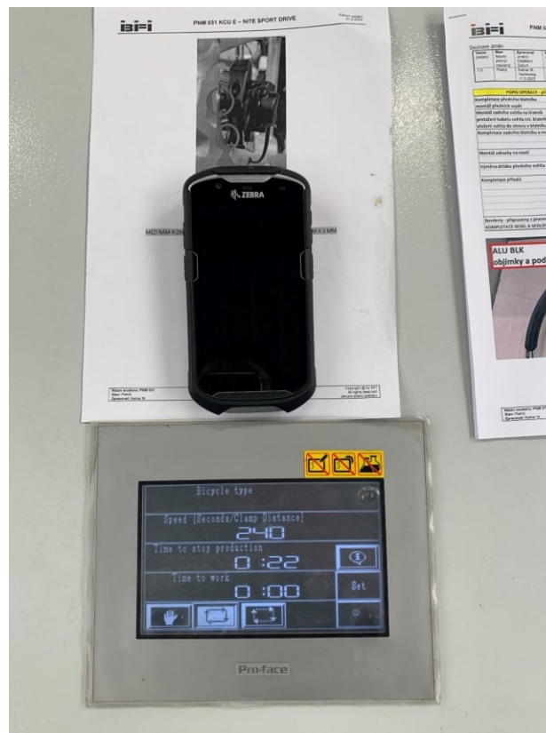
Obrázek 27 Displej montážní linky k nastavení taktu Zdroj: Vlastní
