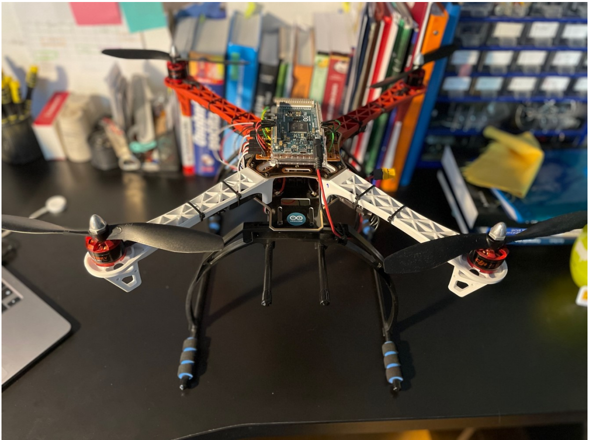
Obrázek 32. Konečný model kvadrokoptéry
