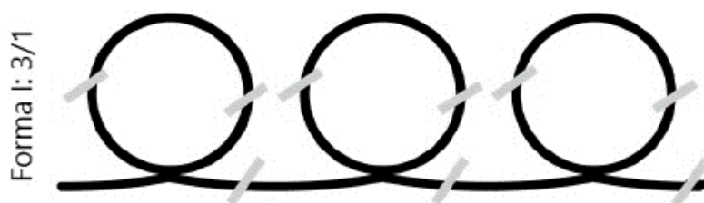
Obrázek 8 Struktura šroubovice formy I PB-1 (3 monomerní jednotky na 1 otáčku šroubovice) [16]
