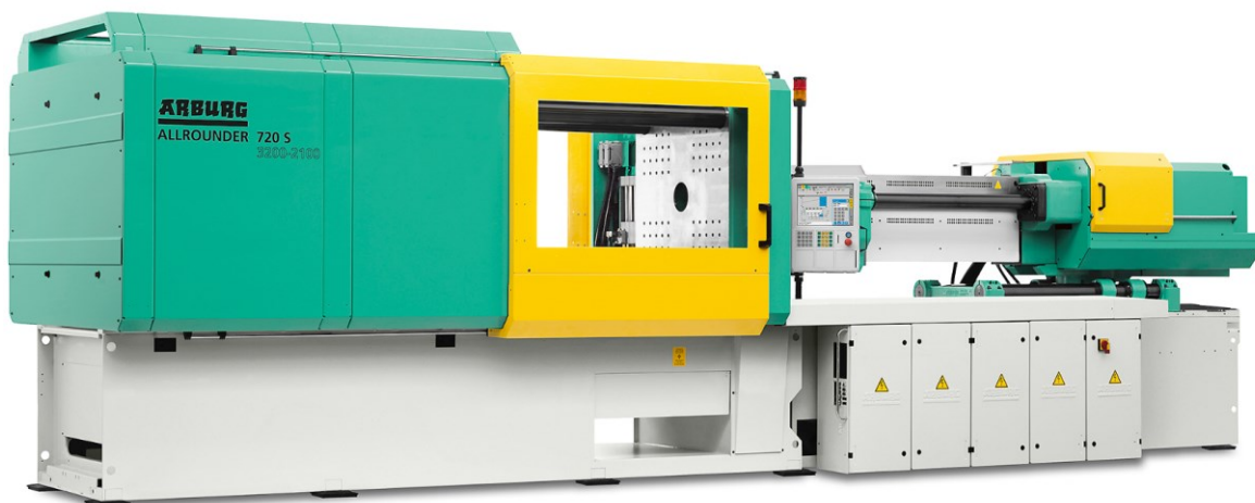
Obrázek 56 Vstřikovací stoj Arburg Allrounder 720 S [27]
