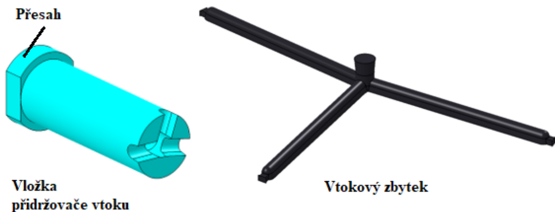
Obrázek 44 Vložka přidržovače vtoku a vtokový zbytek
