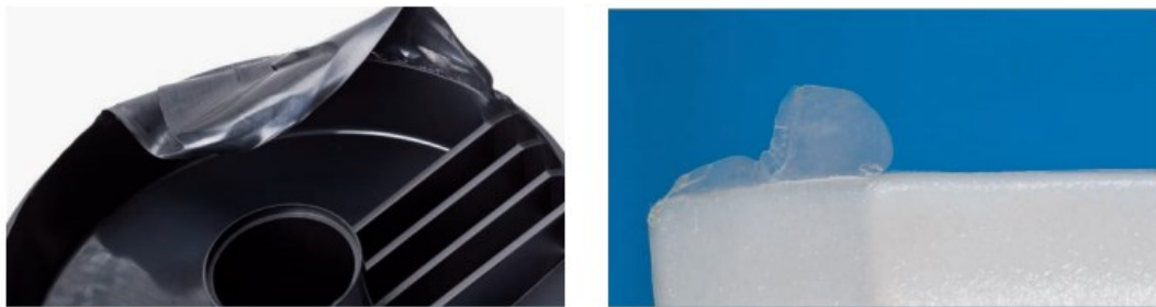
Obrázek 14 Ukázky přetoků na výrobcích [15]
