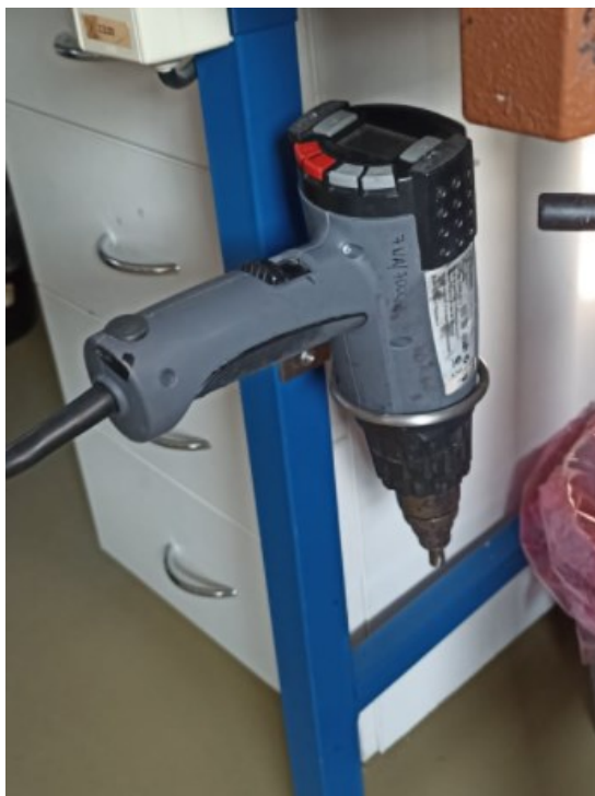
Obrázek 42 Návrh podoby držáku horkovzdušné pistole pod pracovní plochou (vlastní zpracování)
