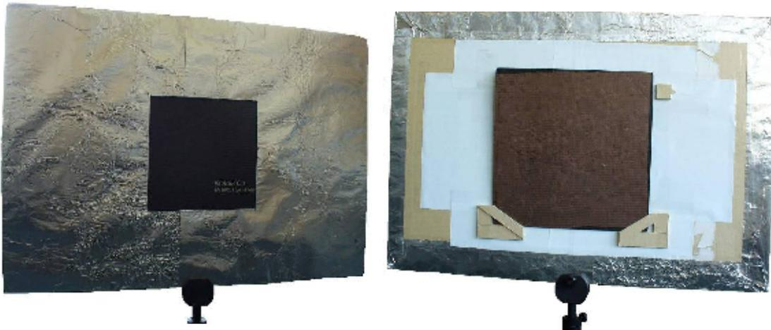
Obr. 27 Zařízení pro odstínění okolí měřených vzorků (přední, zadní strana)
