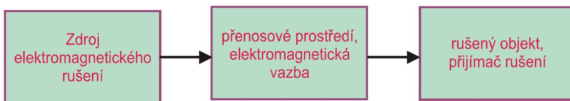
Obr. 1 Základní řetězec EMC a příslušné příklady u jednotlivých oblastí [1]
