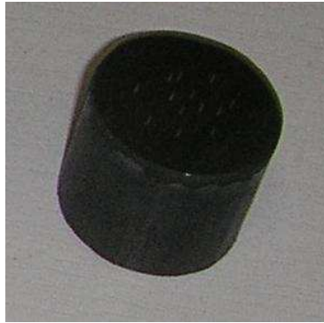
Obr. 32. Povrchově kalený zkušební vzorek
