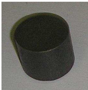
Obr. 38. Vzorek s nitridovanou vrstvou
