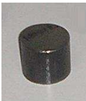
Obr. 21. Zkušební vzorek z oceli 14 220
