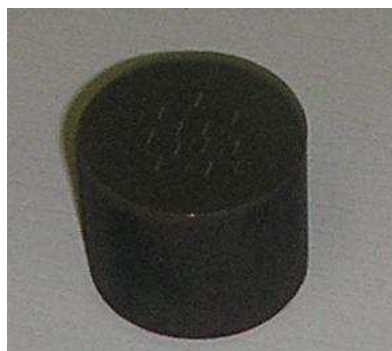
Obr. 26. Zkušební vzorek z ušlechtilé oceli
