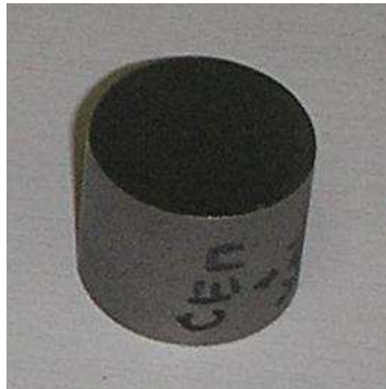
Obr. 43. Vzorek cementovaný a kalený
