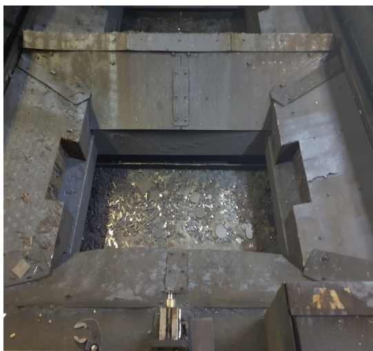
Obrázek 26 Místo, kde odpadá materiál při pálení (vlastní zpracování)
