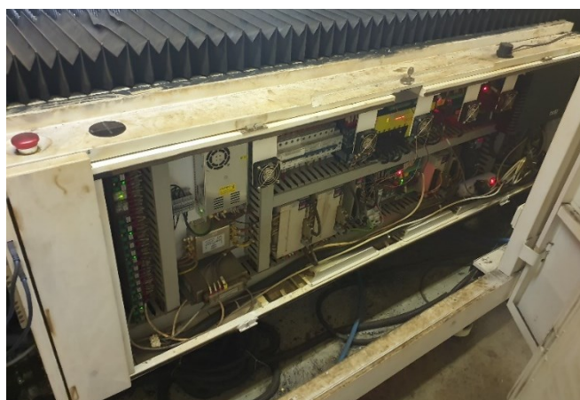
Obrázek 25 Elektrická skříň laseru (vlastní zpracování)
