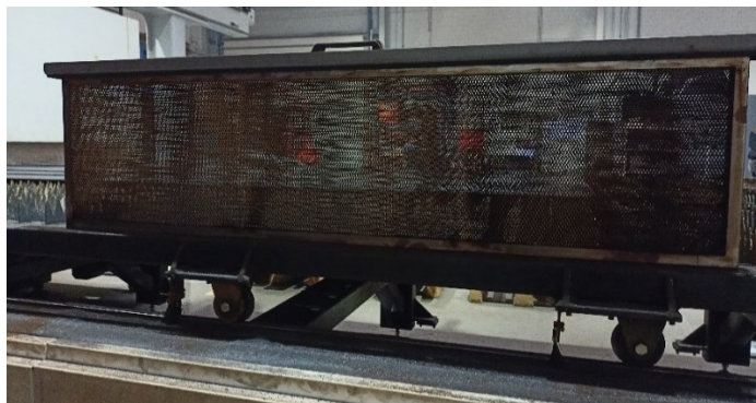
Obrázek 24 Lapač jisker (vlastní zpracování)
