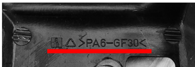
Obr. 65 Značka materiálu vyznačená na vnitřní straně výrobku
