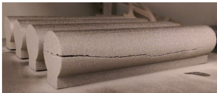
Obr. 56 Vznik praskliny způsobené zbytkovým napětím [54]
