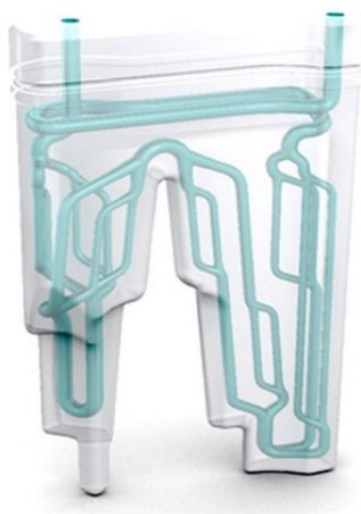
Obr. 46 Vaskulární systém s průměry kanálků 3, 2,12 a 1,5 mm. [39]
