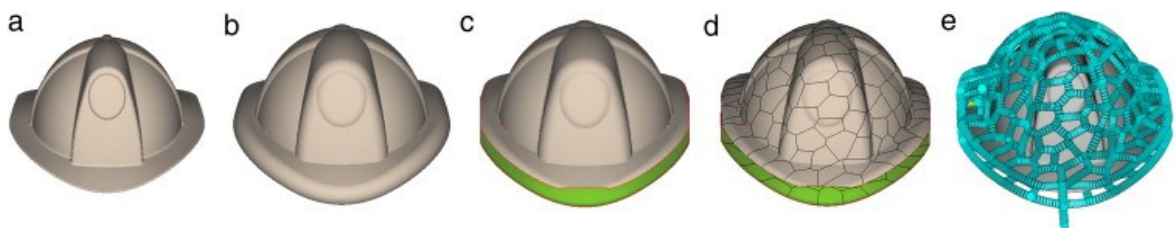
Obr. 45 Proces tvorby temperačního systému dle Voroného diagramu [34]
