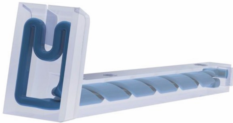
Obr. 44 Variabilní průřez konformních kanálků [37]
