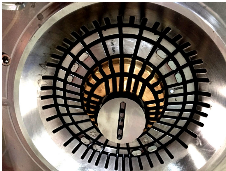
Obr. 40 Tvarové vložky z vysoce tepelně vodivé slitiny mědi [30]
