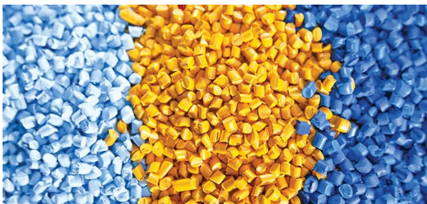
Obr. 10 Polymery v podobě granulátu pro následné zpracování [11]
