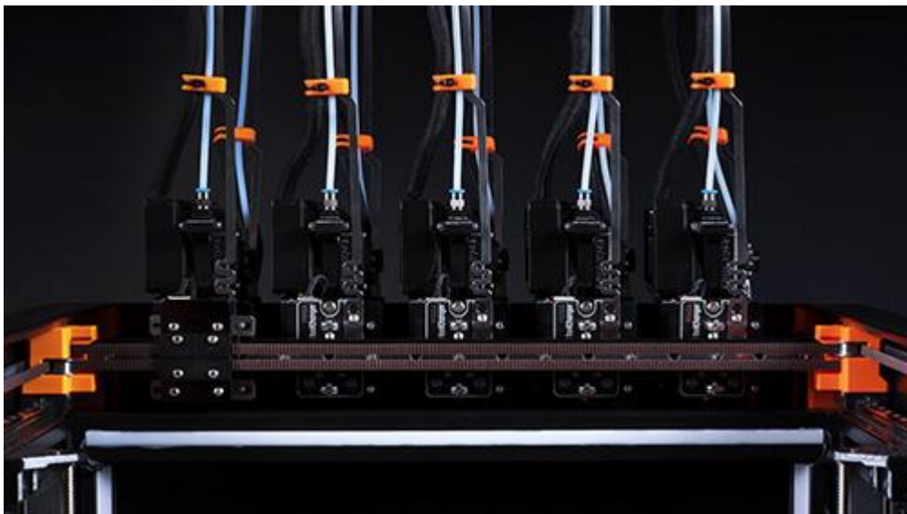
Obr. 9: Tiskárna s vyměnitelnými tiskovými hlavami [18]
