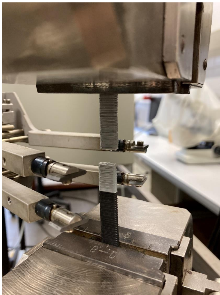
Obr. 65: Průběh tahové zkoušky kolmo na vrstvy
