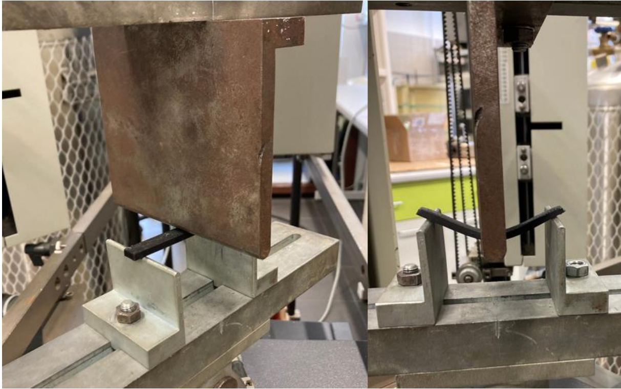
Obr. 80: Průběh zkoušky trojbodého ohybu
