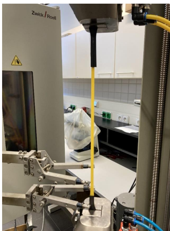
Obr. 24: Průběh tahové zkoušky sendviče
