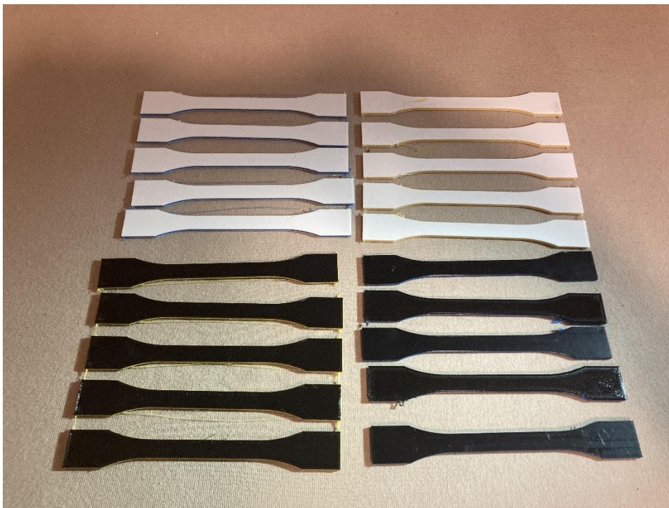
Obr. 23: Vytisknuté zkušební vzorky pro tahovou zkoušku dle ISO 527-2/1B
