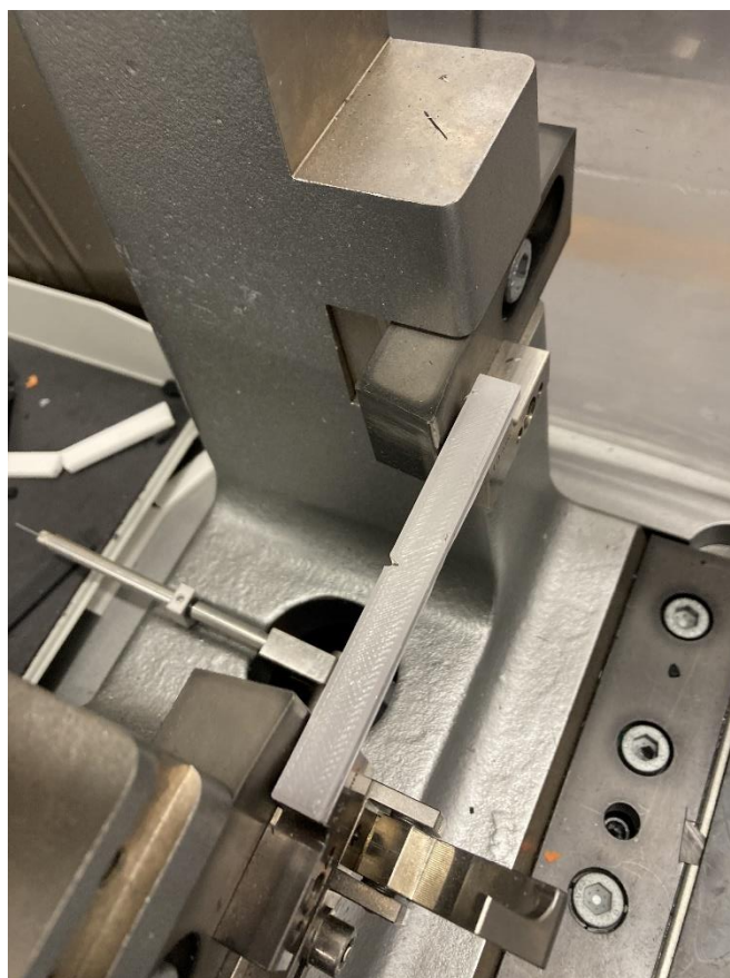
Obr. 53: Průběh rázové zkoušky vrubové houževnatosti Charpy
