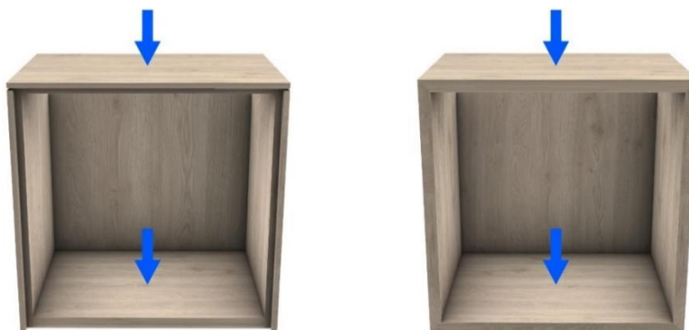
Obr.13 Ukázka míst pro stálé zatížení – 28,2 kg pro plochu dna a 1.patro police, vzorek č.1 (vlevo) a vzorek č.2 (vpravo)
