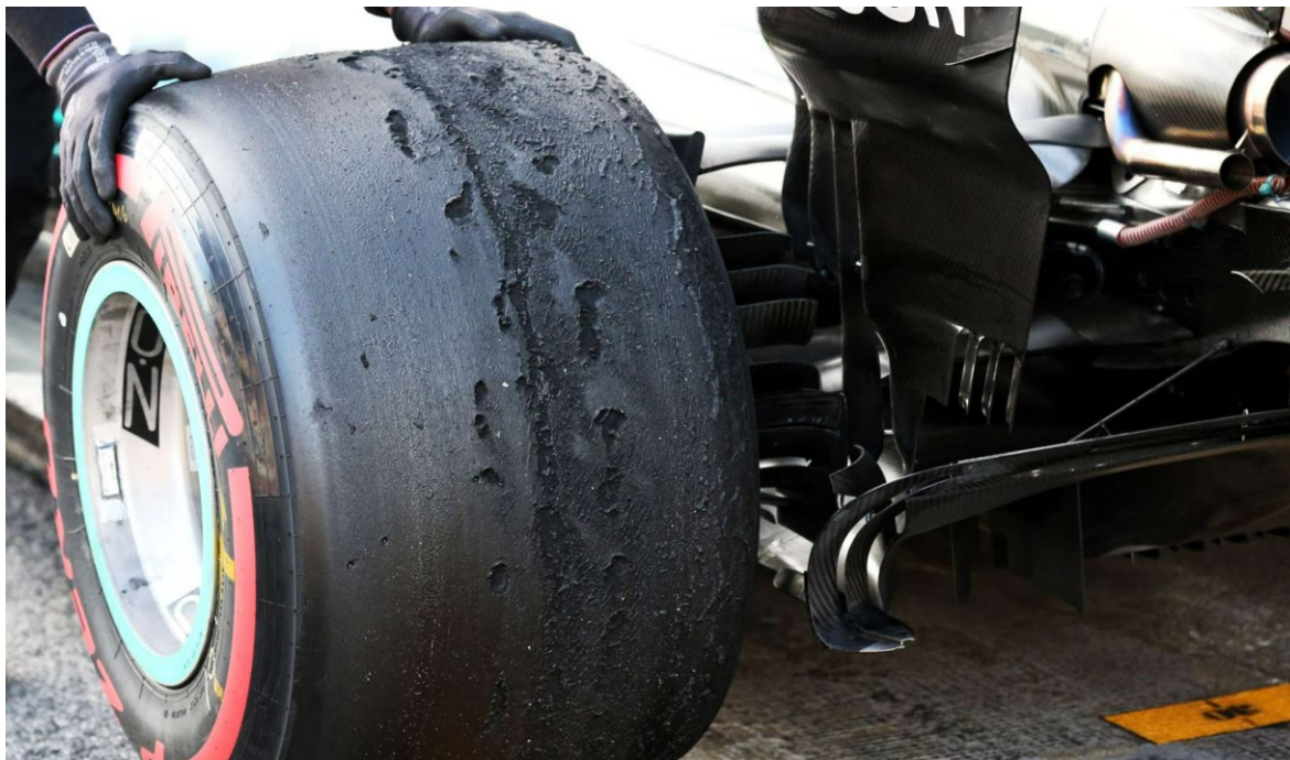
Obrázek 24 Opotřebení pneumatik závodního vozu (Racefans, 2018)
