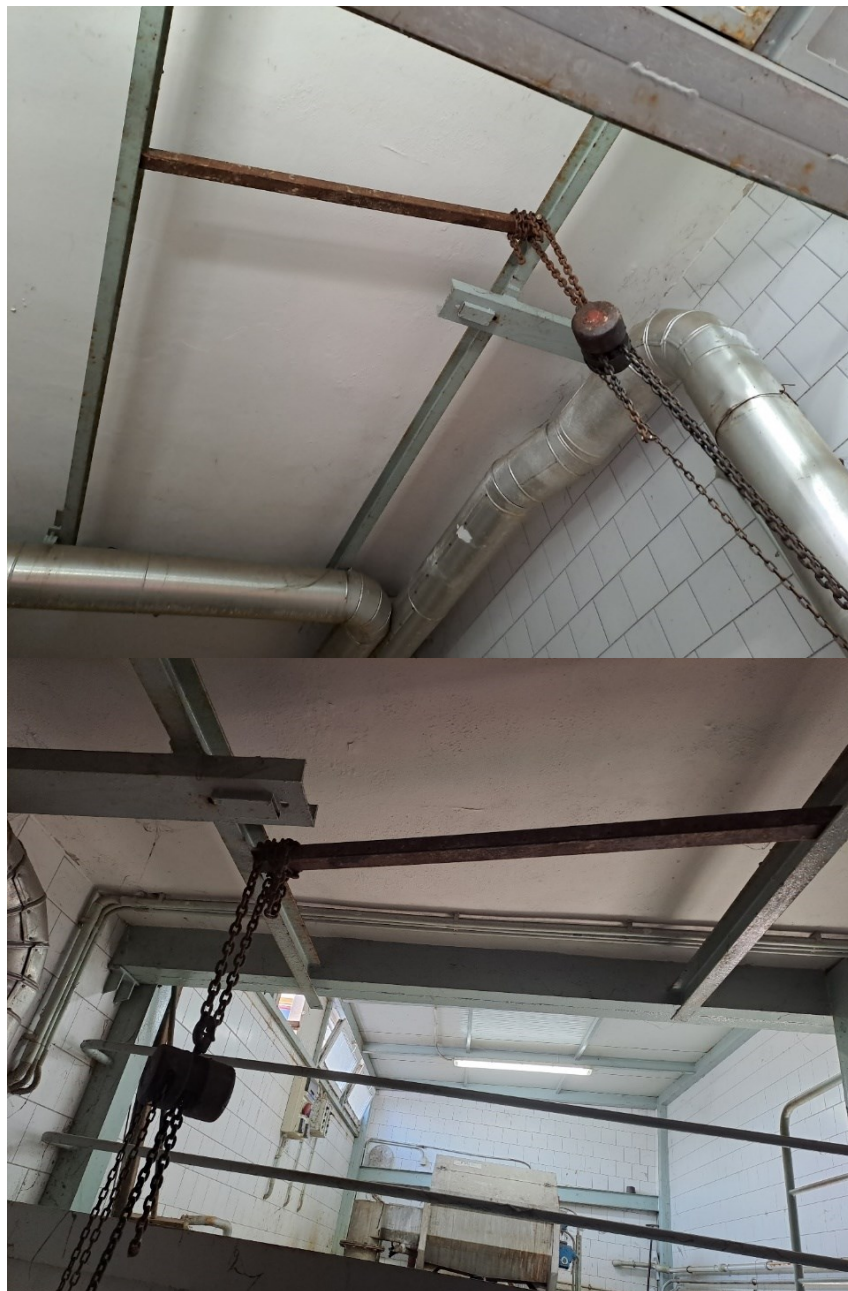
Obrázek 15 – Nevhodné umístění ručního kladkostroje (vlastní)
