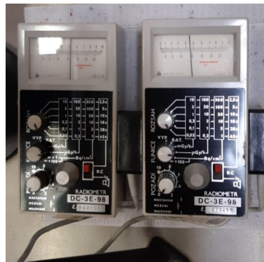
Obrázek 23 – Umístění indikační jednotky DC-3E-98 v měřicím vozíku. (foto autor)
