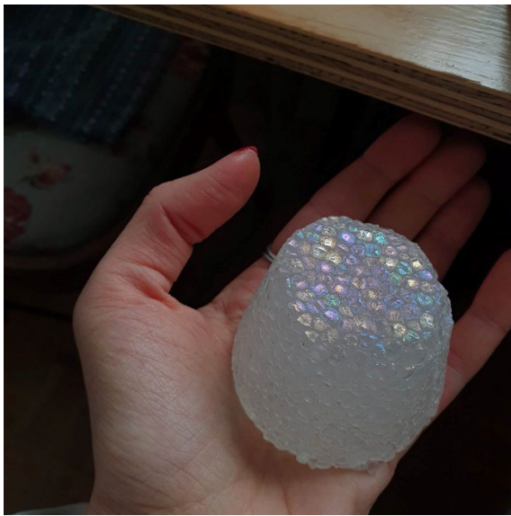
Obrázek 22- První zkoušky tavení korálek v mase
