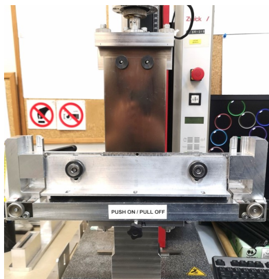
Obrázok 32. Usporiadanie skúšobného prípravku pre meranie vzoriek strešného profilu
