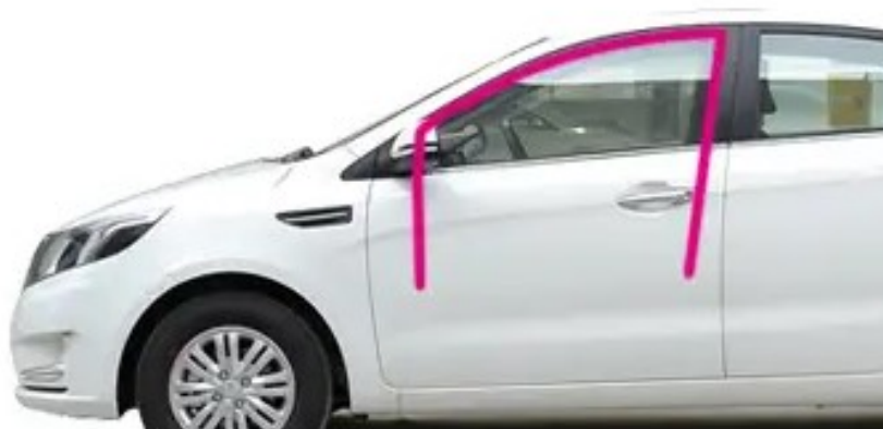
Obrázok 1. Tesnenie vedenia skla [2]
