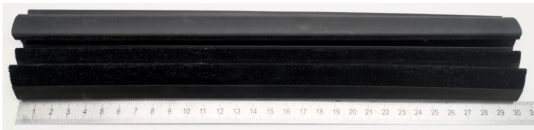
Obrázok 35. Vzorka strešného profilu o dĺžke 300 mm
