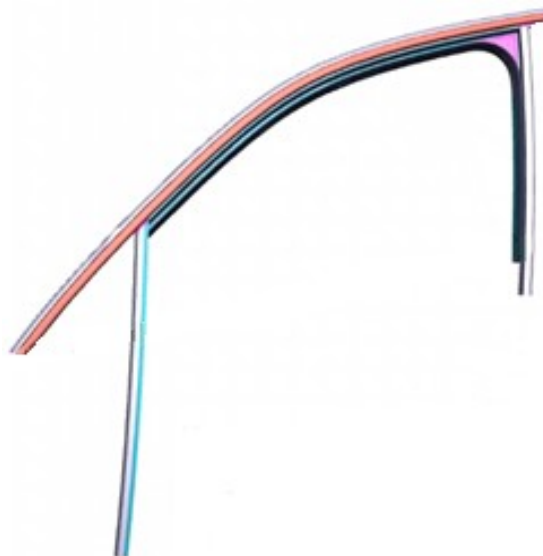
Obrázok 2. Tesnenie vedenia skla – predné ľavé, SG
