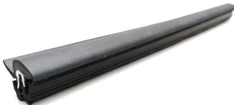
Obrázok 36. Vzorka strešného profilu po orezaní jazykov
