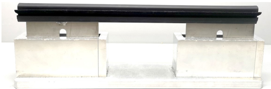
Obrázok 37. Vzorka strešného profilu narazená na pomocné plechy
