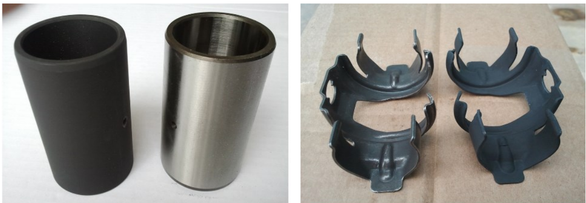
Obr. 9: Obrobky s povlakem fosforečnanu manganu a bez něj. [16]
