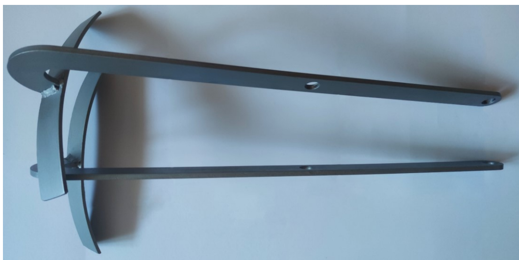
Obrázek 43 Svařence po antikorozičním nátěru
