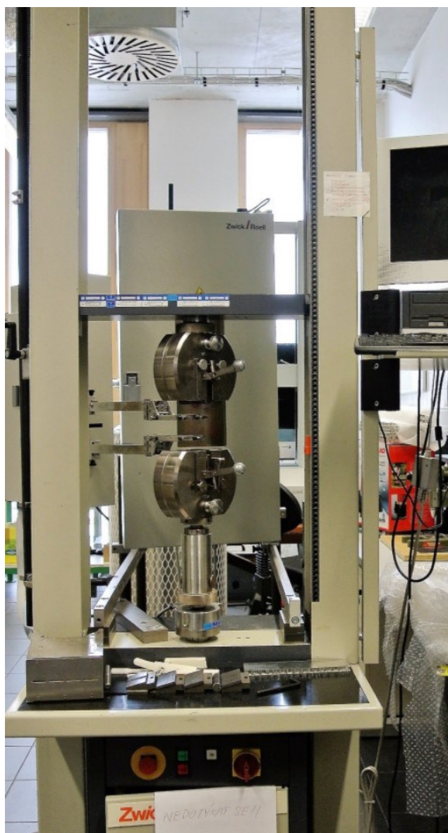
Obrázek 17 Univerzální zkušební stroj Zwick/Roell 1456 s čelistmi a extenzometrem pro zkoušku tahem
