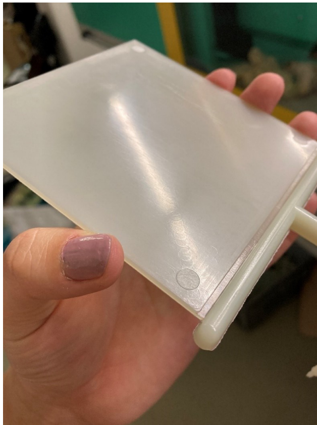
Obrázek 13 Destička s vtokovým systémem po vyjmutí z formy
