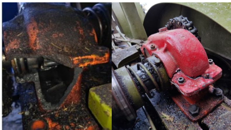
Obr. 31 Prasklá skříň převodovky
