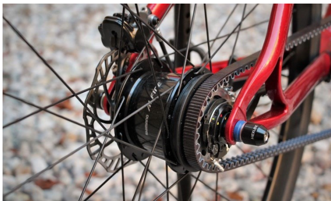
Obr. 21 Zadní náboj s řemenem (zdroj: cyclingabout.com)
