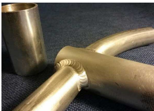
Obr. 14 Svařování rámu kola (zdroj: 1xmatch.com)
