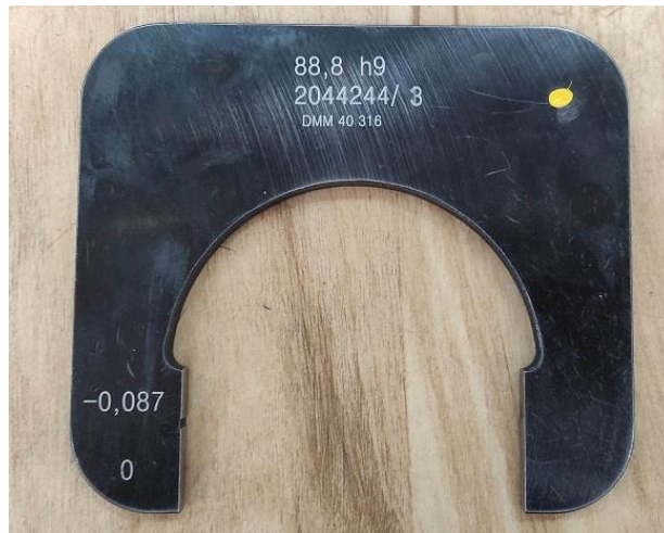
Obrázek 38 Kalibr pro měření vnějšího opracovaného průměru 88,8h9
