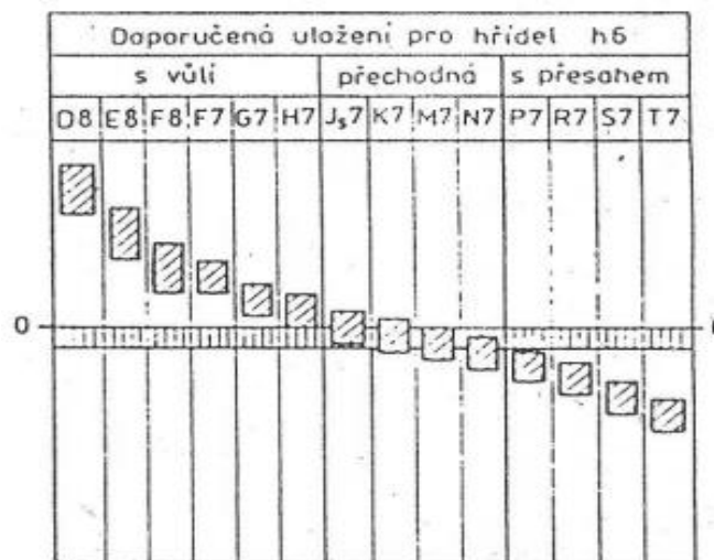
Obrázek 9 Uložení v soustavě jednotného hřídele
