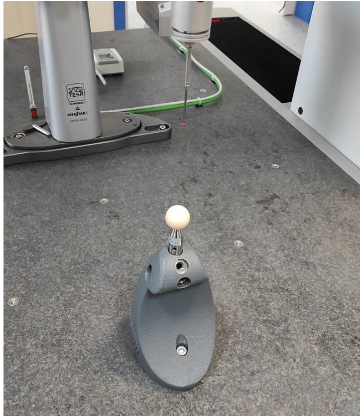
Obrázek 43 Sonda připravená na kalibraci a kalibrační kulička
