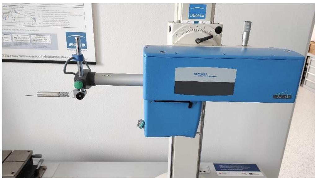
Obrázek 48 Drsnoměr Waveline T8000 využitý při měření drsnosti.
