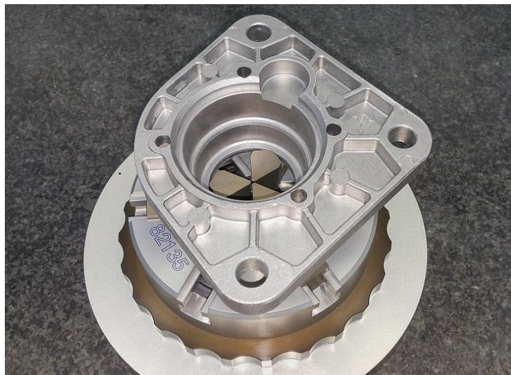
Obrázek 49 Upnutí víka ve sklíčidle při měření pomocí souřadnicového měřicího stroje
