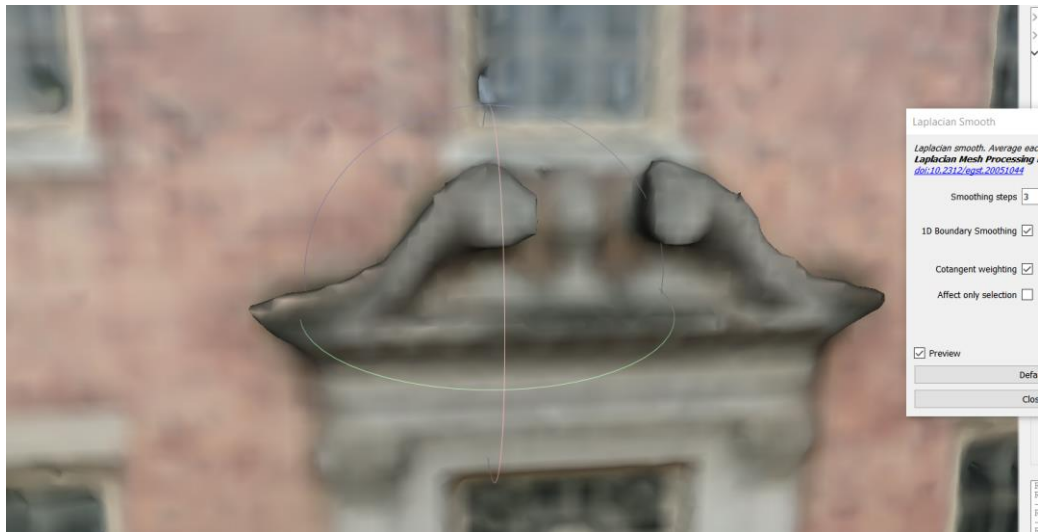
Obrázok 38 Ukážka algoritmu s kotangensovým vážením
