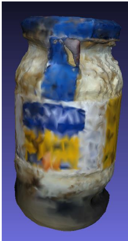
Obrázok 93 Ukážka „mesh“-u po aplikovaní algoritmu „ Quadric Edge Collapse Decimation “
