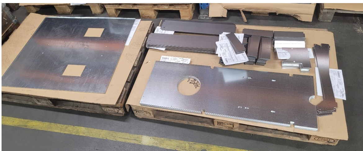
Obrázek 19 Produkty různých velikostí čekající na provedení ohybů (vlastní zpracování)
