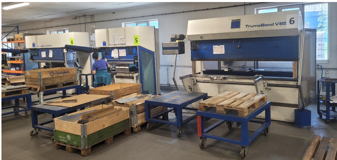
Obrázek 21 Různé typy ohraňovacích strojů (vlastní zpracování)
