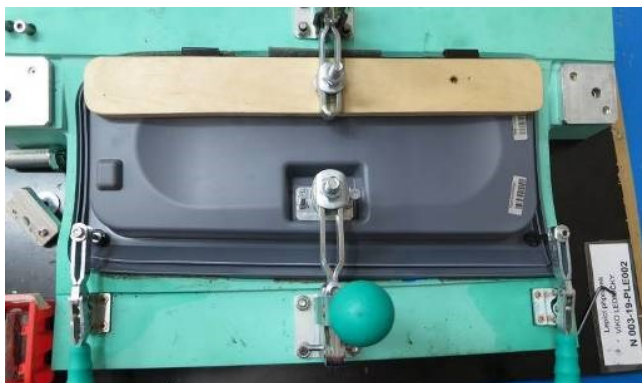
Obrázek 12 Víko lednice zafixované v pomocném přípravku pro předmontáž víka lednice (vlastní foto)
