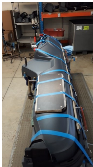
Obrázek 13 Zafixovaná PD v hlavním přípravku (vlastní foto)
