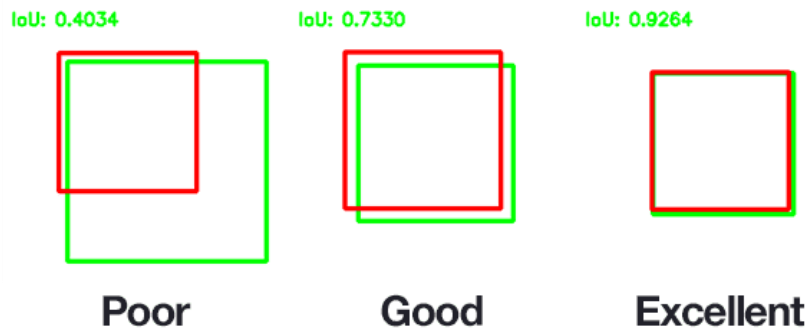
Obrázek 14. Příklad výpočtu IoU pro různé bounding boxy [34]
