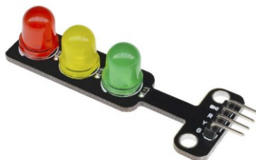
Obrázek 5 Modul LED semaforu [16]
