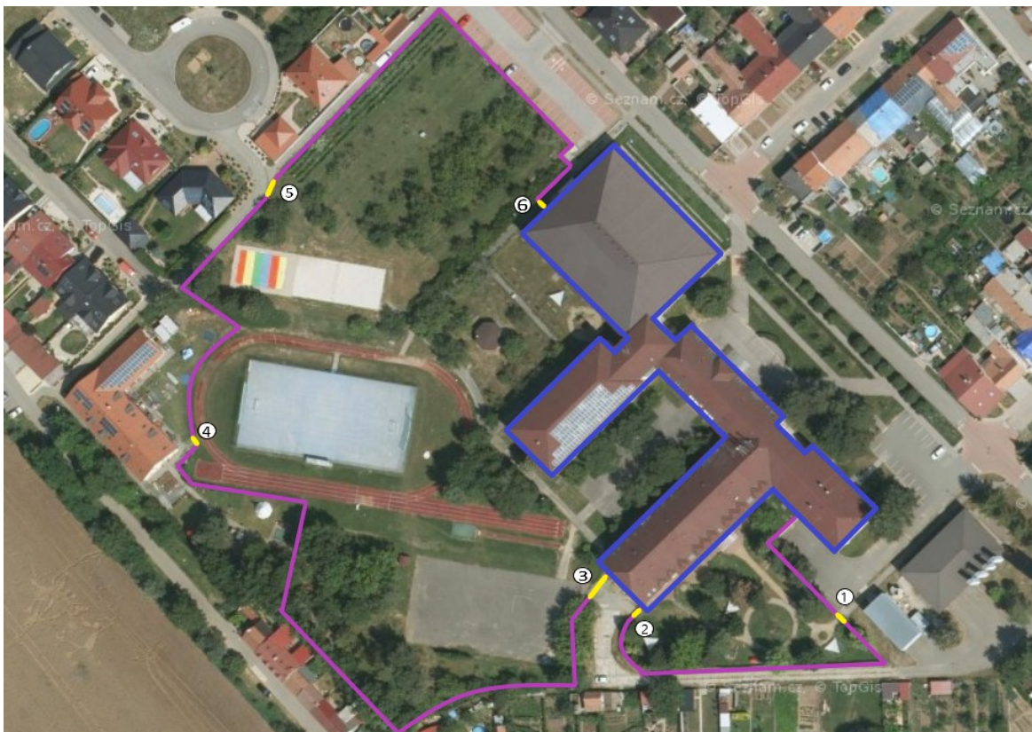
Obrázek 10. Perimetrická ochrana objektu. Upraveno z [22]
