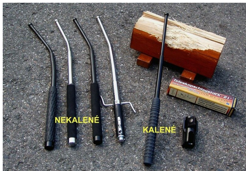
Obrázek 6 Rozdíl při použití mezi kaleným a nekalenými obuškami [18]
