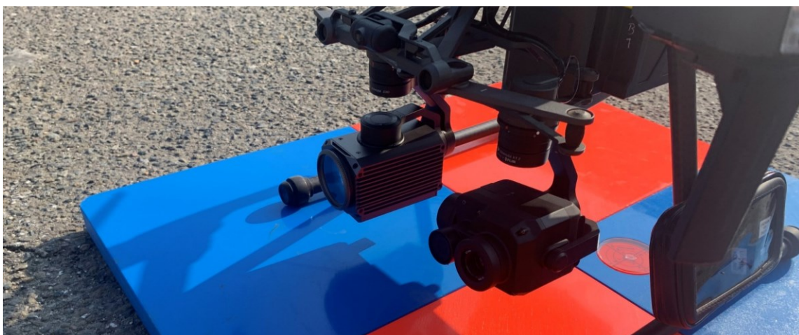
Obrázek 34 - Kamera a termokamera dronu (Zdroj vlastní, 2023)
