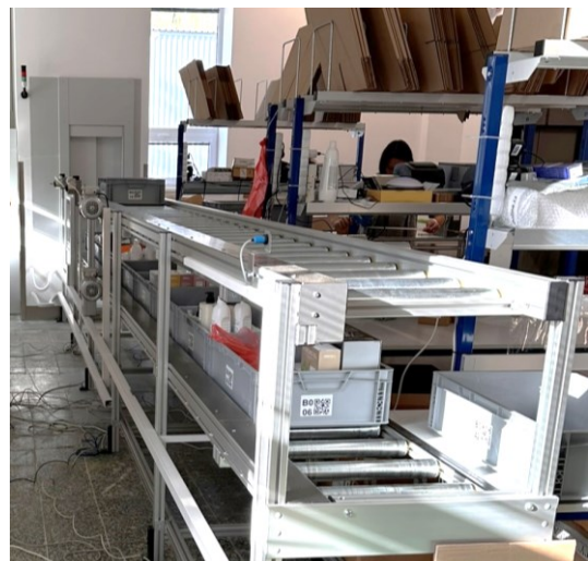
Obrázek 10 Dopravník a výtah v 1. NP (zdroj: Vlastní foto)
