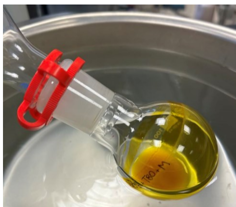
Obrázek 18 Vzorek směsi P407/T80/M při přípravě metodou tenkého filmu
