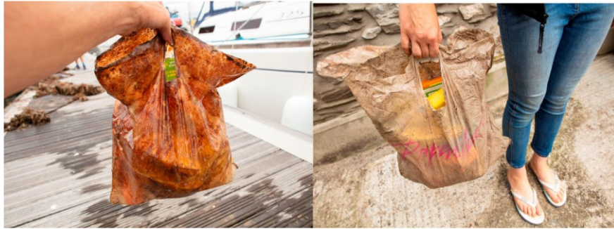
Obrázek 7: Tašky vyrobeny z oxo-degradabilního materiálu po 3 letech. Vlevo taška vytažená z moře, vpravo taška pohřbená v půdě. Obě tašky byly schopny udržet 2,25 kg potravin [41].
