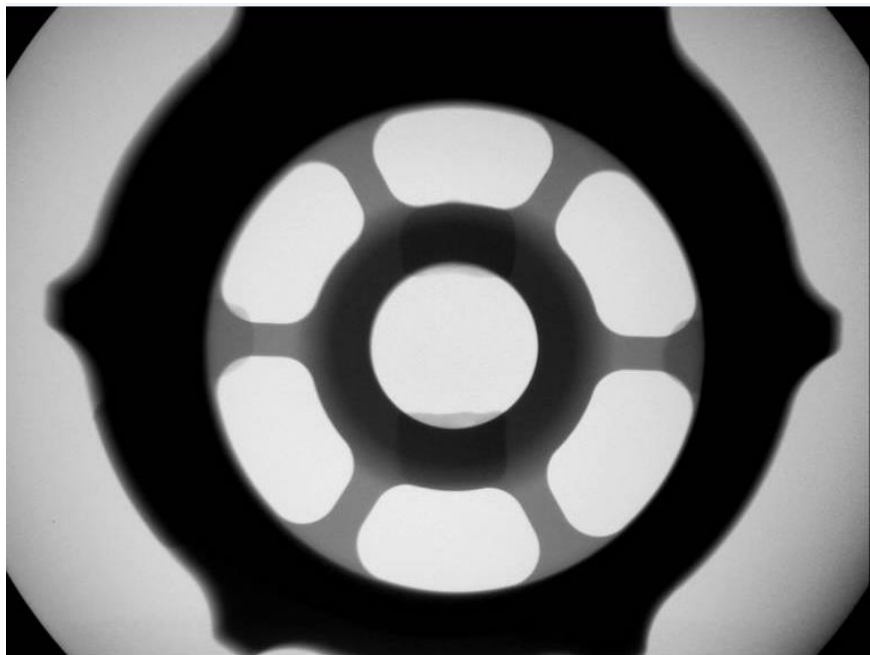
Obrázek 42 Odlitek bez RTG vady (zdroj Mesit foundry)
