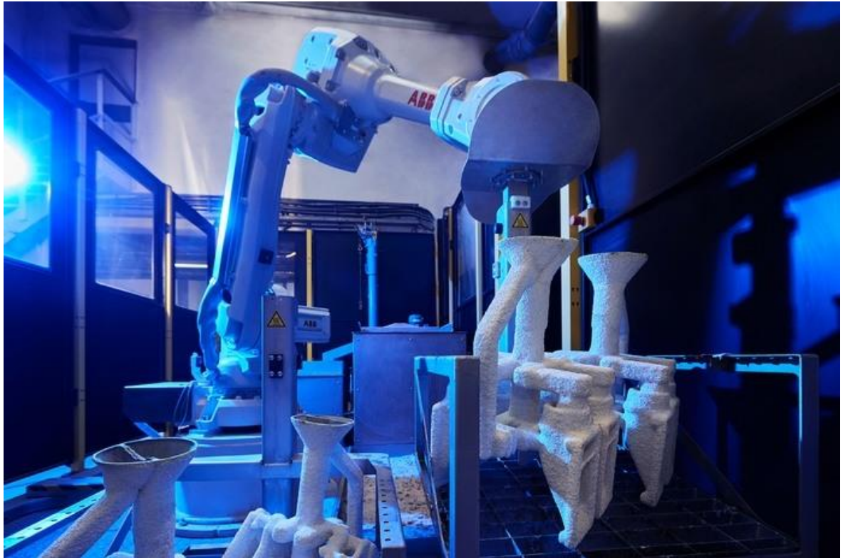
Obrázek 18 Robotizované pracoviště řízeného tuhnutí (Mesit foundry, © 2024)
