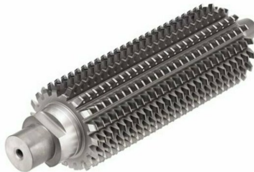
Obr. 4 Odvalovací fréza pro výrobu ozubených kol [34]
