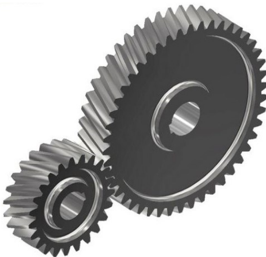
Obr.2 Ozubená kola s šikmými zuby [22]
