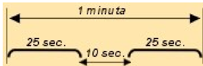
Obrázek 3 Požární poplach. (GŘHZSČR, 2024)
