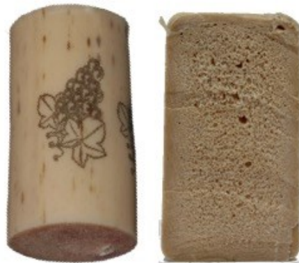
Obr. 3 Zátka z TPE vyrobena s použitím nadouvadel [2]
