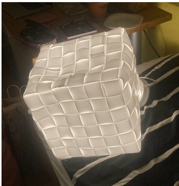
Obrázek 35 – zkouška prosvícení [autorova knihovna]
