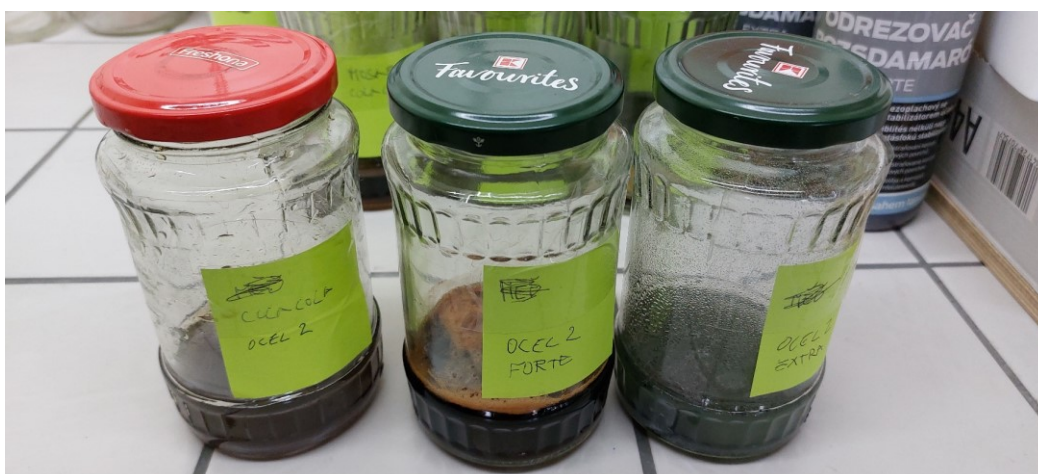
Obrázek 20 Vzorky oceli I a III po 2 týdnech působení v chemickém prostředí
