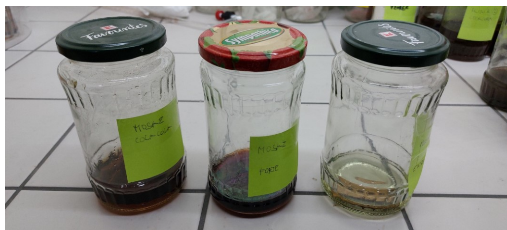
Obrázek 18 Vzorky mosazného pásu po 2 týdnech působení v chemickém prostředí
