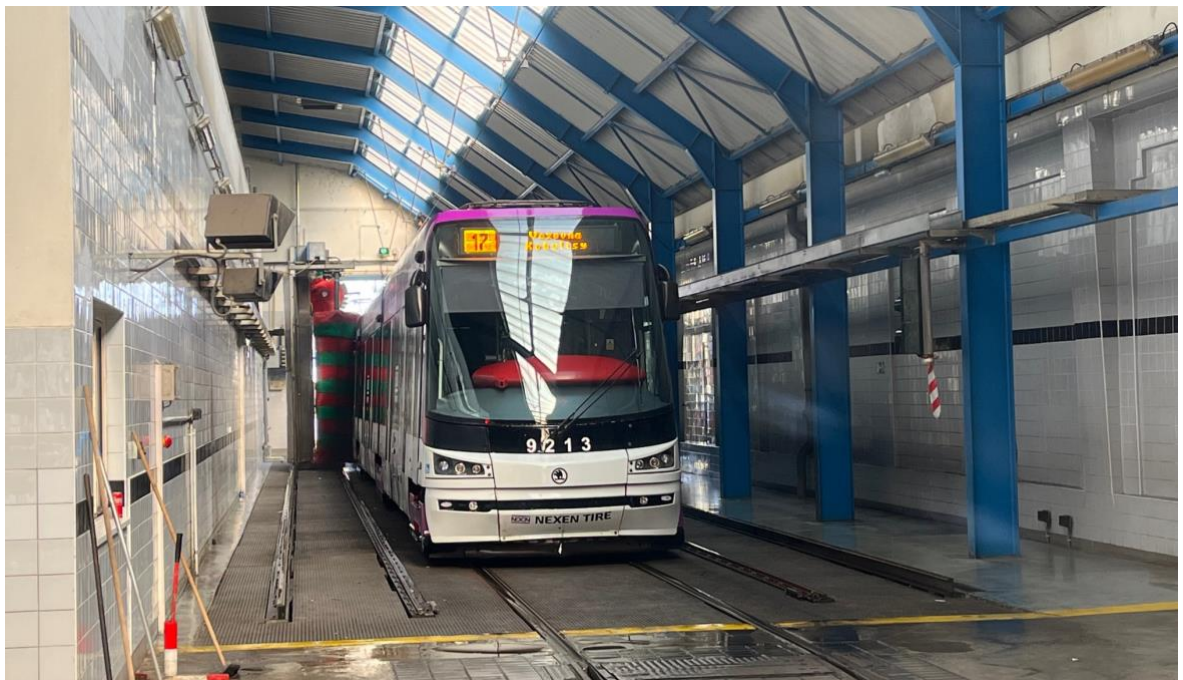
Obrázek 6: Tramvaj 15T v mycí lince (Vlastní zpracování)
