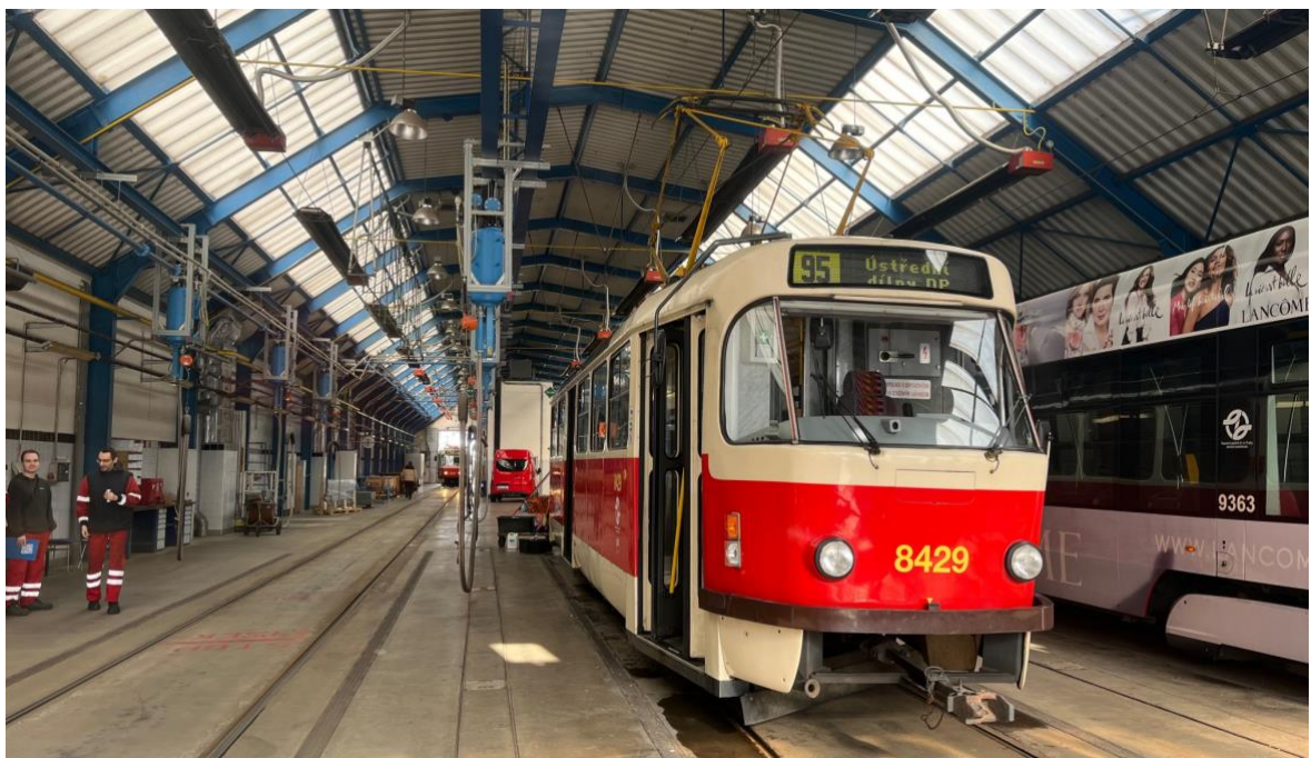
Obrázek 2: Tramvaj T3R.P na doplnění písku (Vlastní zpracování)
