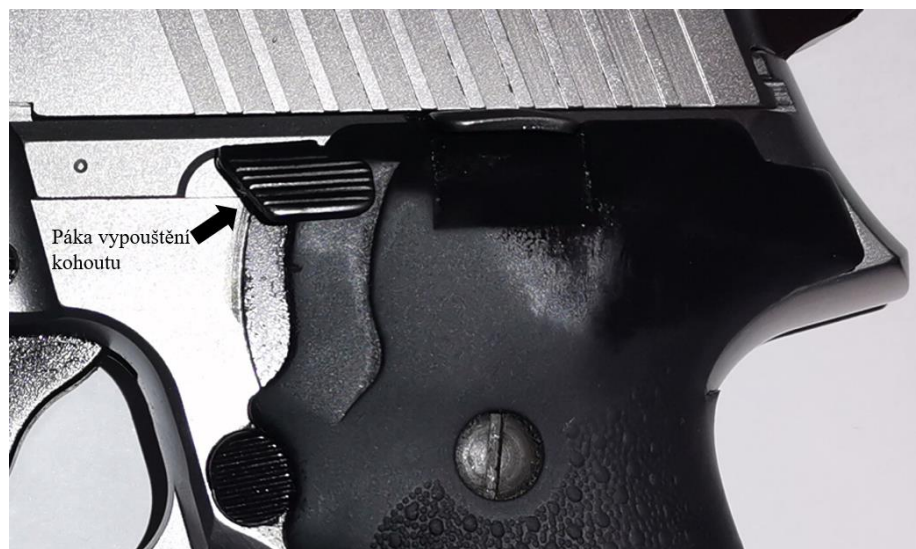
Obrázek 3: Páka vypouštění kohoutu u pistole SIG Sauer P226
