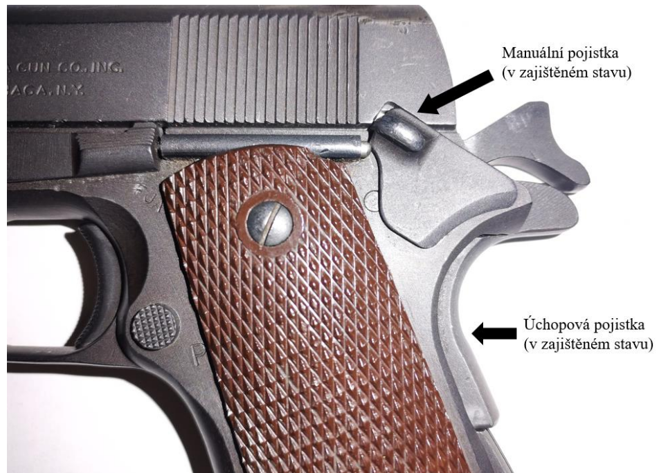
Obrázek 2: Manuální a úchopová pojistka u pistole modelu 1911
