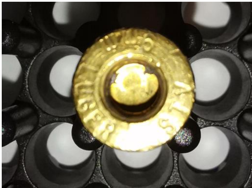
Obrázek 1: Náboj, jehož nábojnice nemá zátravku
