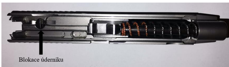
Obrázek 6: Blokace úderníku u pistole SIG Sauer P226
