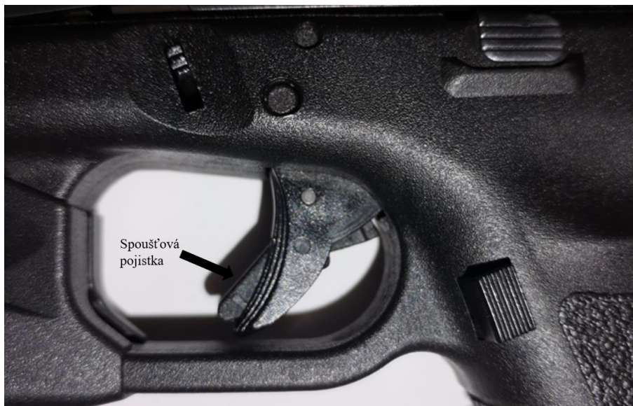
Obrázek 4: Spoušťová pojistka u pistole Glock 17
