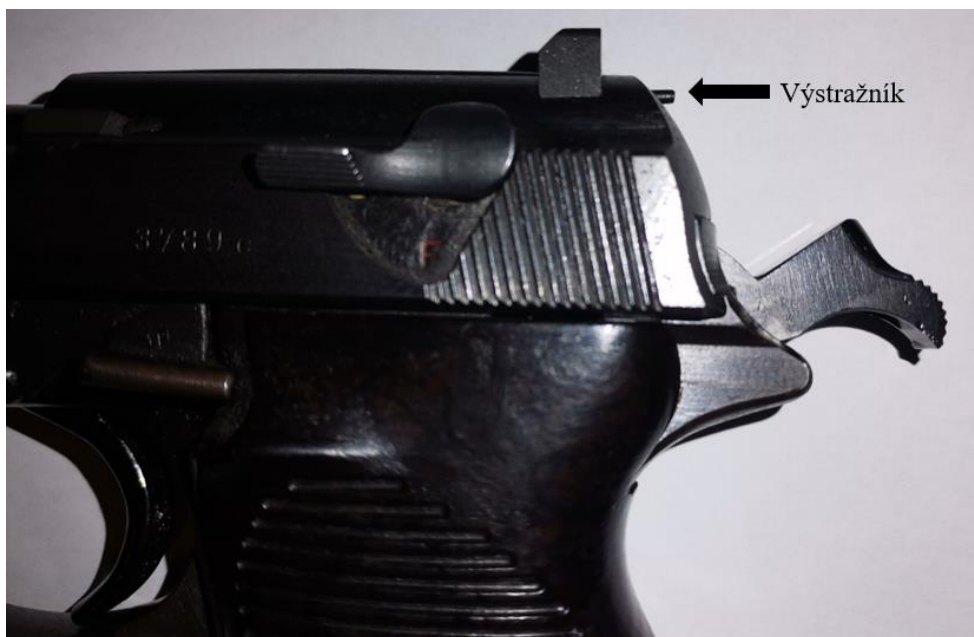
Obrázek 5: Výstražník indikující náboj v komoře u pistole P.38
