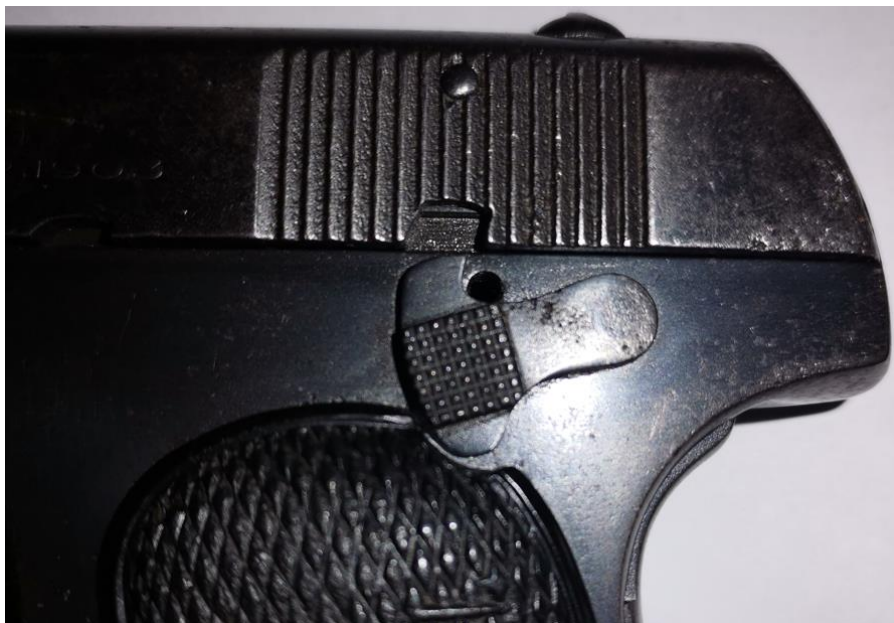
Obrázek 7: Detail manuální pojistky pistole Colt 1908 z výbroje šanghajské městské policie
