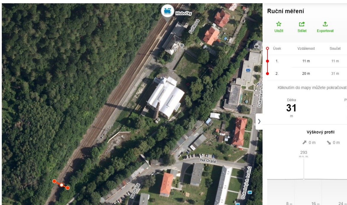
Obrázek 14 Stanice Hlubočky a blízké okolí trati – nedodržení ochranného pásma dráhy
