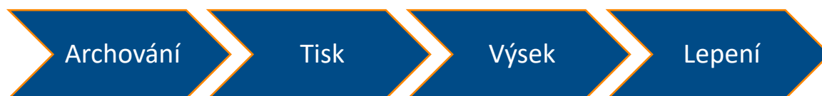
Obrázek 7: Schéma výrobního procesu zpracování kartonu (vlastní zpracování)
