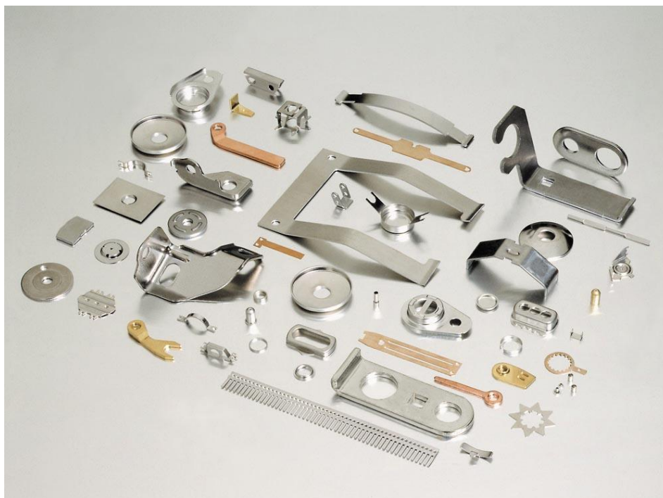
Obr. 1 Příklady součástí vyrobených ve sruženém nástroji [2].
