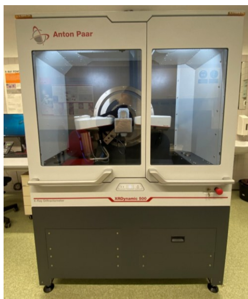
Obrázek 13 Rentgenový difraktometr XRDynamic 500 (Anton Paar s.r.o, Česká republika).
