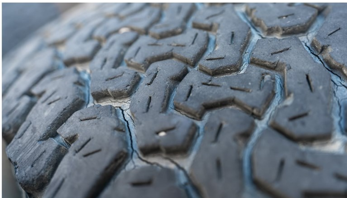
Obrázek 7 Tvorba trhlin na povrchu pneumatiky vlivem působení ozonu. [26]
