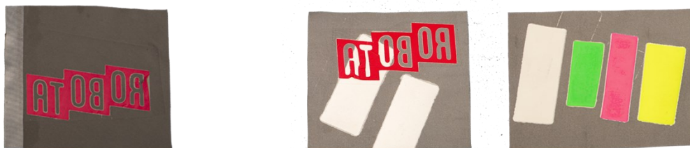
Obr. 44. Řezaná nažehlovací fólie na softshellu a reflexní našivací pásce [28]
